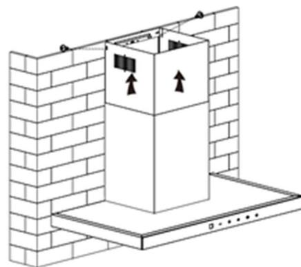
**Korrektter Anschluss Abluftschlauch (nur bei Abluftbetrieb)**
