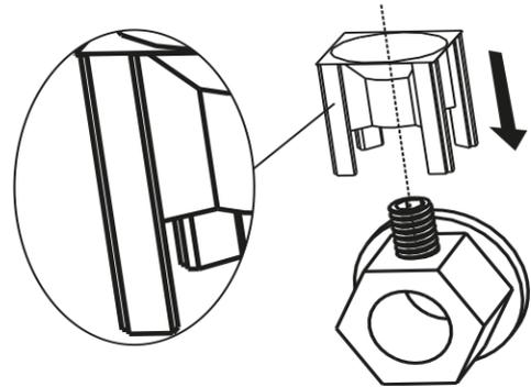
Achten Sie darauf, das Führungselement korrekt aufzusetzen. Es muss komplett abschließend und passgenau auf der Mutter aufsitzen.
