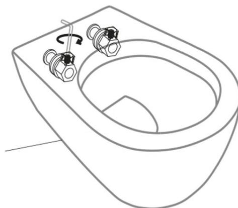
Prüfen Sie durch sanftes Rütteln, ob die Verbindung absolut fest und sicher ist, bevor Sie mit der Montage des WC-Sitzes fortfahren.
