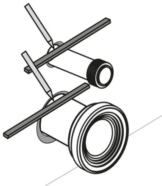
2. Schieben Sie als nächsten die beiden Rohre ebenfalls bis zum Anschlag in Ab- und Zulauf des WCs. Markieren Sie dann auch auf dieser Seite der Rohre die Position des Abschlusses mit der Rückseite des WCs.
